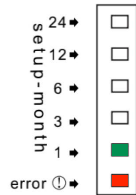
Abb. 9.1 Kein Motorimpuls erkannt (Batterie fast leer)
