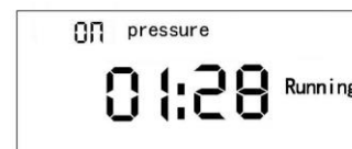
Abb. 24.3 Display für Schmierzeit 3P zählt aufwärts
