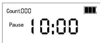
Abb. 23.2 Pausenzeit Display nach erstem Anschluss an Spannung
