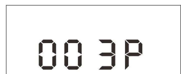
Abb. 24.6 Einstellung 3P Schmierzeit „Minuten“
