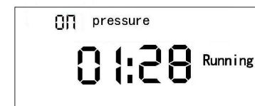
Abb. 25.3 Display für Schmierzeit 3P zählt aufwärts
