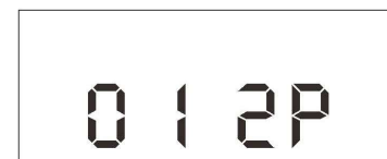
Abb. 23.5 Einstellung 2P Verteilerüberwachung Zyklen
