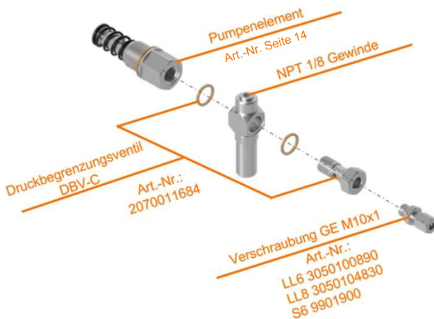
Abb. 16.2 Explosionszeichnung PE mit gerader Verschraubung
