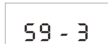
Abb. 23.7 Einstellung 3P - Schmierzeit „Sekunden“
