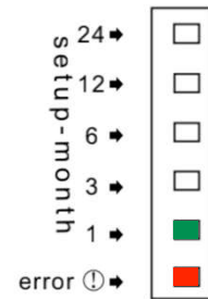
Abb. 9.1 Kein Motorimpuls erkannt (Batterie fast leer)
