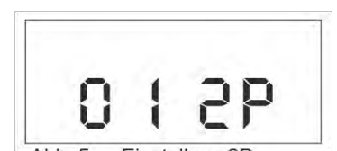
Abb. 5 Einstellung 2P Verteilerüberwachung Zyklen
