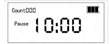
Abb. 2 Pausenzeit Display nach dem ersten Anschluss an die Spannung
