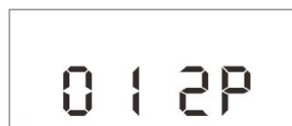
Abb. 23.5 Einstellung 2P Verteilerüberwachung Zyklen
