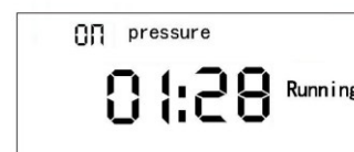
Abb. 24.3 Display für Schmierzeit 3P zählt aufwärts
