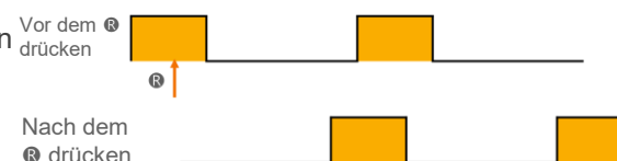
Abb. 24.5 Schmierzeit ändert sich durch drücken der Ⓡ Taste während der Schmierzeit
