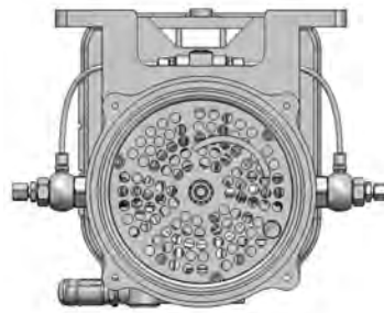
Abb. 18.3 Pumpe mit zwei Bypässen u. zwei DBV-A
