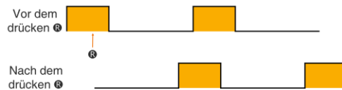
Abb. 2 Zyklus ändert sich durch Drücken der ⏮ Taste während der Schmierzeit
